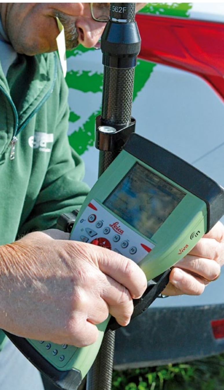
Mittels eines GPS-Empfängers wird ein Punkt für eine neue Streckenmarkierung eingemessen.
